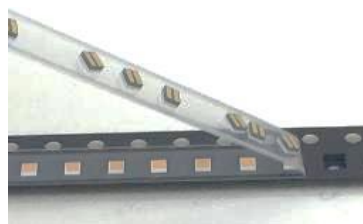
図 18. 帯電による LED 貼りつき
