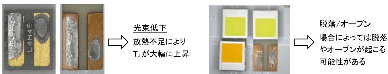
図 10. はんだ量不足による不具合事例
