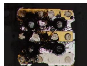
突入電流による損傷 (LED チップ電極部分)
